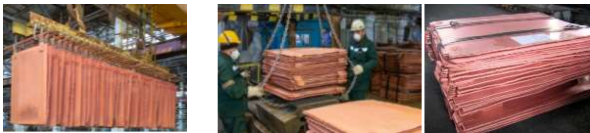
Рисунок 1.9 – Маркировка и упаковка катодной меди
