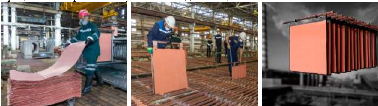
Рисунок 1.2 – Производство меди в Цехе электролиза меди на Балхашском медеплавильном заводе
