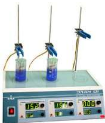
Рисунок 2.2 – Общий вид лабораторной электролизной установки ЭЛАМ-01
